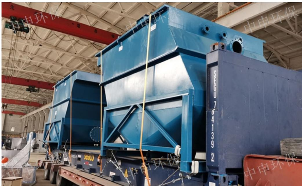
在工业废水和生活废水处理中，有一种很重要的物化处理方法：混凝法。这种水处理方法应用比较多，各种污染指标去除率高。混凝的目的在于通过向水中投加一些药剂（通常称为混凝剂及助凝剂），混凝剂在水中通过电离和水解等化学作用使水中难以沉淀的胶体颗粒能互相聚合而形成胶体，然后通过胶体的压缩双电层作用、吸附电性中和、吸咐架桥作用和沉析物网捕作用等与水体中的杂质和有机物胶体结合形成更大的颗粒絮体，颗粒絮体在水的紊流中彼此易碰撞吸附，形成絮凝体。絮凝体具有强大吸咐力，不仅能吸咐悬浮物，还能吸咐部分细菌和溶解性物质。絮凝体通过吸咐，体积增大而下沉。通过斜板沉淀池沉淀下的絮体沉淀于设备锥形泥斗中定期排出外运或经污泥脱水设备处理后外运。
